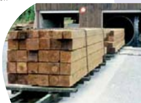
Procédé de traitement des bois par autoclave
